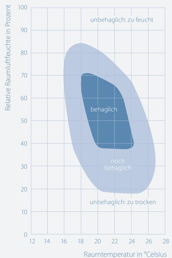
Bedarfsorientierte Raumautomation rückt den Mensch in den Mittelpunkt. Sie berücksichtigt, wann Räume genutzt werden und sorgt gezielt für die grösstmögliche Behaglichkeit in puncto Wärme, Kühlung, Frischluft, Licht und Beschattung. Der Energieaufwand dafür ist so gross wie nötig und so gering wie möglich.
