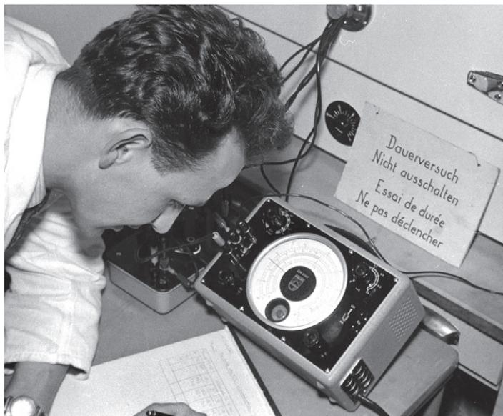
Essais de durée visant à exclure les processus de détérioration
